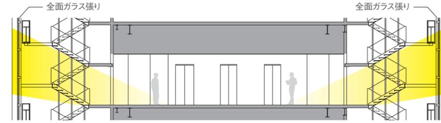
上下階を結ぶ階段は全面ガラス張り。常開式の防火扉としているため、スムーズな移動が可能です。敷地特性を利用し、閉鎖的になりがちなオフィスビルの階段を明るい開放的な空間に変えました。
